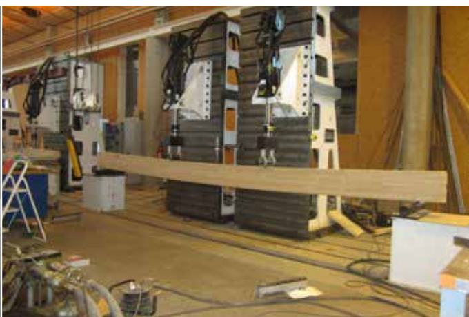
Essai de flexion 4 points d'une poutre lamellée-collée en châtaignier dans les laboratoires du FCBA de Bordeaux.
